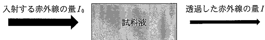
図 1 試料液に赤外線を入射したときの模式図
